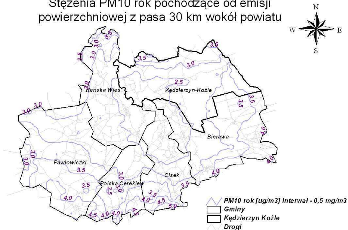
Rysunek 53 Stężenia pyłu zawieszonego PM 10 o okresie uśredniania wyników rok kalendarzowy, w powiecie kędzierzyńsko-kozielskim, pochodzące od emitorów powierzchniowych zlokalizowanych w pasie 30 km wokół powiatu w 2005 r.
