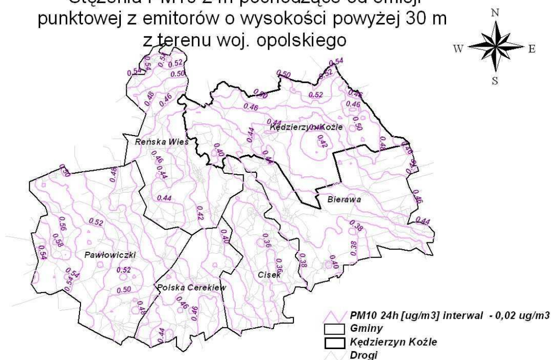
Rysunek 48 Stężenia pyłu zawieszonego PM 10 o okresie uśredniania wyników 24 godziny, w powiecie kędzierzyńsko-kozielskim, pochodzące od emitorów punktowych o wysokości komina powyżej 30 m z terenu województwa opolskiego w 2005 r.
